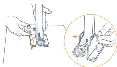
**Tauchrohr arrettieren:** Schraube durch beide Schenkel des Haltewinkels sowie die Bohrung im Rohr führen und Griffmutter leicht anziehen.
