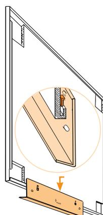
Stiftablage an der Rückseite der Tafel vormontieren.
