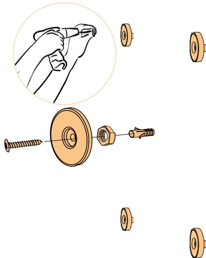
Magnethalterungen wie abgebildet montieren.
