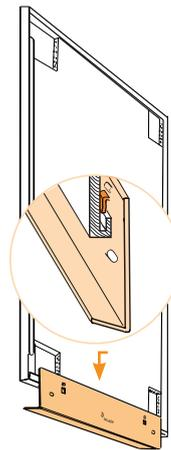
Stiftablage an der Rückseite der Tafel vormontieren.
