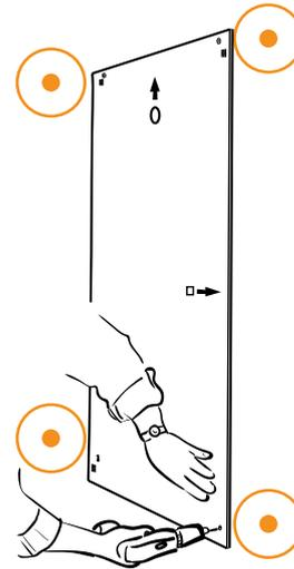
Vier Löcher durch die runden Markierungen vorbohren.
