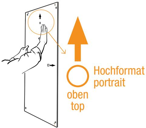
Schablone in der gewünschten Position an der Wand anlegen und mit einer Wasserwaage ausrichten.
