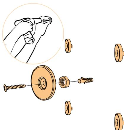
Magnethalterungen wie abgebildet montieren.
