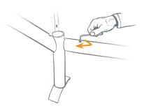
Gewindeschrauben fest anziehen Firmly tighten the tapping screws
