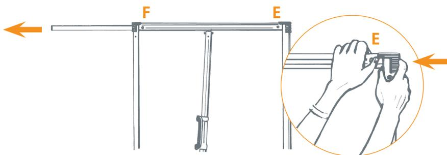
Druckknopf drücken (E), Zusatzblatthalter einschieben, von anderer Seite herausziehen und einrasten lassen (F).
