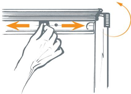
Papierabrißklappe nach oben öffnen. Pins auf Lochabstand schieben, Papier einhängen und mittig ausrichten. Klappe schließen.
