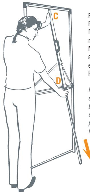
Rückseitiges Stützbein ausklappen, Rändelschraube lösen, Druckknopf an Führungsrohr mit linker Hand drücken (C). Mit anderer Hand Stützbein nach unten ausziehen und einrasten lassen (D). Rändelschraube festziehen.
