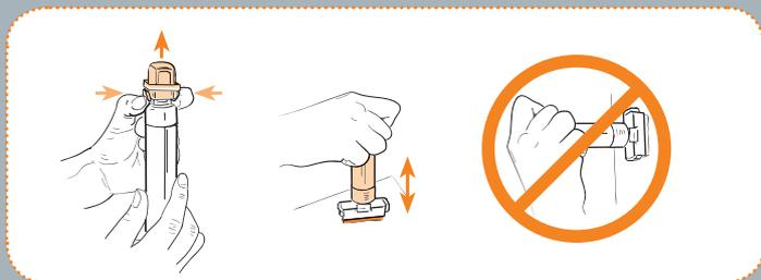
Zum Öffnen des Deckels die seitlichen Laschen zusammendrücken und Deckel nach oben abnehmen. Druck auf die Markerspitze startet den Tintenfluss (ca. 2–3 mal pumpen reicht). Papier unterlegen und nur auf waagerechter Fläche pumpen (nicht an der Tafel)!
