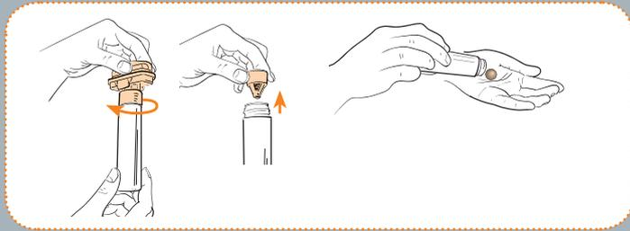
Deckel im Uhrzeigersinn abschrauben. Ventil nach oben entnehmen und Glasmurmel aus dem Tank nehmen.
