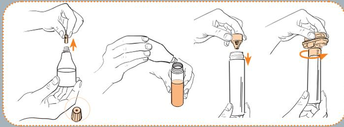
Versiegelung aus Nachfüllflasche entfernen und Tinte in den Tank des FatOnes gießen. Ventil wieder einsetzen und Deckel mit Schreibspitze im Gegenuhrzeigersinn aufschrauben.
