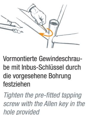
**Vormontierte Gewindeschraube mit Inbus-Schlüssel durch die vorgesehene Bohrung festziehen**
