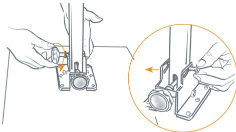
**Tauchrohr arretieren:** Schraube durch beide Schenkel des Haltewinkels sowie die Bohrung im Rohr führen und Griffmutter leicht anziehen.
