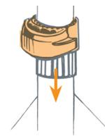
**Kabelführung auf Klemmring aufstecken**
